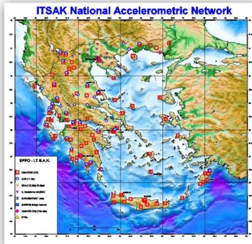
Σχήμα 10: Χάρτης με τις θέσεις των μόνιμων σταθμών επιταχυνσιογράφων του Δικτύου του ΙΤΣΑΚ (Ινστιτούτο Τεχνικής Σεισμολογίας και Αντισεισμικών Κατασκευών) έως τον Οκτώβριο του 2012 στον Ελληνικό χώρο. Είναι σε εξέλιξη η ολοκλήρωση της εγκατάστασης δικτύου νέων επιταχυνσιογράφων (περίπου 100 νέοι σταθμοί) σε ολόκληρη τη χώρα μετά από χρηματοδότηση έργου από τον ΟΑΣΠ ( Οργανισμό Αντισεισμικού Σχεδιασμού και Προστασίας ) (Ιστοσελίδα, ΙΤΣΑΚ).
