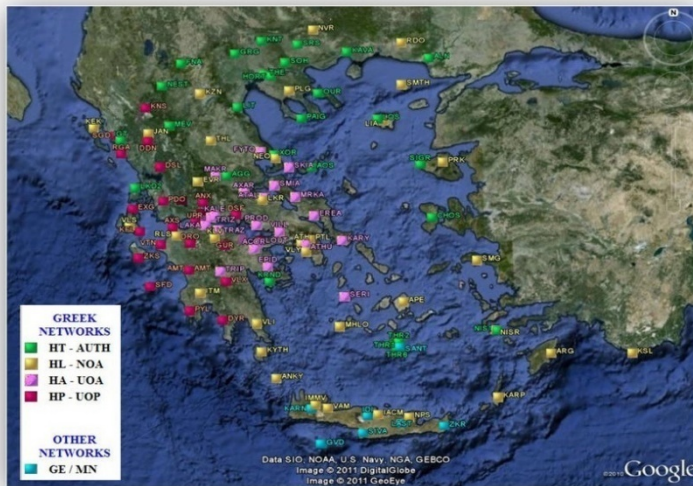
Σχήμα 9: Χάρτης με τις θέσεις των μόνιμων σεισμολογικών σταθμών του Εθνικού Δικτύου Σειсмоγράφων στον Ελληνικό χώρο. Με πράσινα τετράγωνα εμφανίζονται οι σταθμοί του Τομέα Γεωφυσικής του ΑΠΘ, με κίτρινα οι σταθμοί του Γεωδυναμικού Ινστιτούτου του Αστεροσκοπείου Αθηνών, με ροζ οι αντίστοιχοι σταθμοί του Καποδιστριακού Πανεπιστημίου Αθηνών και με κόκκινα οι αντίστοιχοι σταθμοί του Πανεπιστημίου Πατρών (Σεισμολογικός Σταθμός ΑΠΘ).
