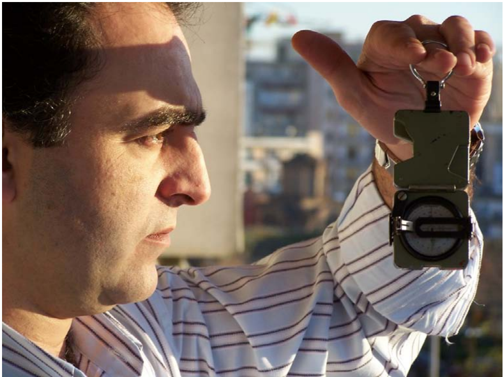
Σχήμα 5. Σπαστή δασική πυξίδα-κλισίμετρο Meridian.
