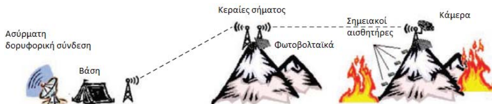
Σχήμα 2: Σύστημα ασύρματου δικτύου αισθητήρων (WSN) (Alkhatib, 2014).
